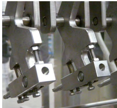
Bezobsługowe łożyska ślizgowe iglidur® X6 wykorzystywane są w systemach dźwigni przełączających chwytających butelki.
