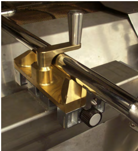
Regulacja położenia rury do nalewania rzadkiego ciasta przy pomocy modułu śruby napędowej drylin® SLW-1040 z regulacją luzu.
