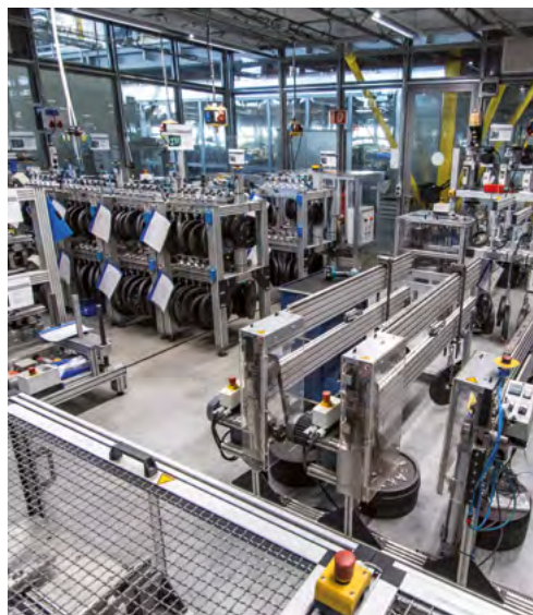
Testy trybologiczne w laboratorium łożysk ślizgowych, igus® Kolonia
