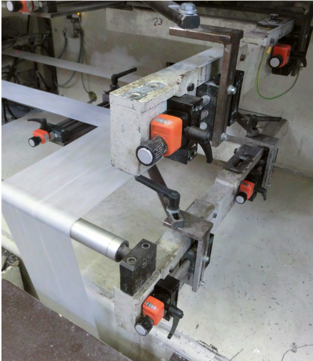
Regulacja środka czterech wstęp przy kącie wychylenia 90° za pomocą modułu śruby napędowej drylin® SHT-12-AWM dla wstęp nietkanych. W układzie używanych jest łącznie osiem systemów.
