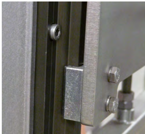
Systemy prowadnic liniowych drylin® W wykorzystano w części zdejmującej etykiety z szyjek. Także one są bezobsługowe oraz odporne na działanie środków czyszczących stosowanych przy produkcji napojów.
