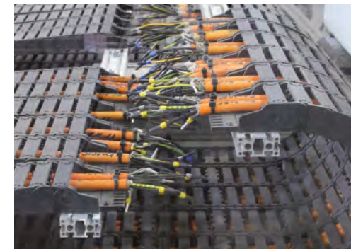
Test wysokiej dynamiki na przewodach igus® chainflex® w e-przewodnikach
